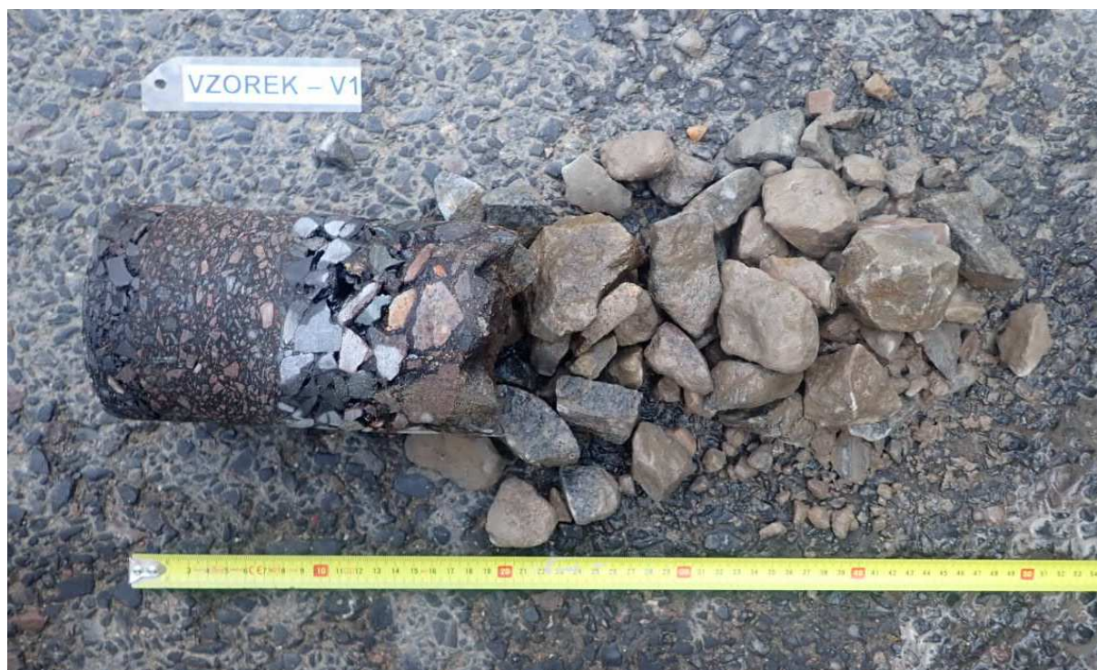
Obr. 1 - Jádro vývrtu Vzorek – V1 (in situ).
