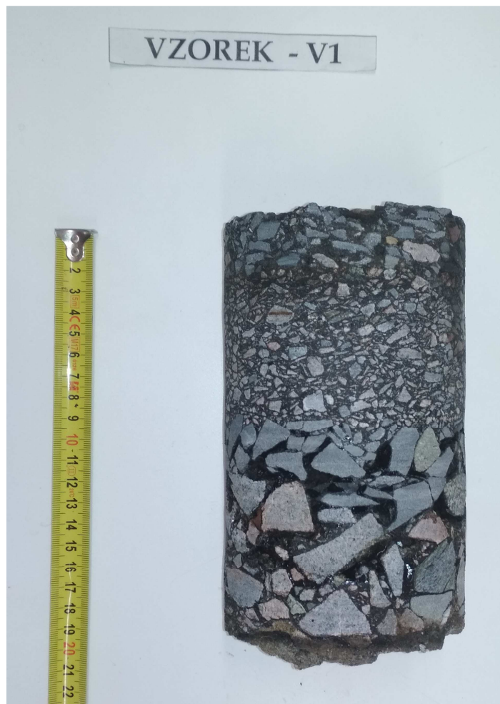
Obr. 2 - Jádru vývrtu Vzorek – V1 (laboratoř).
