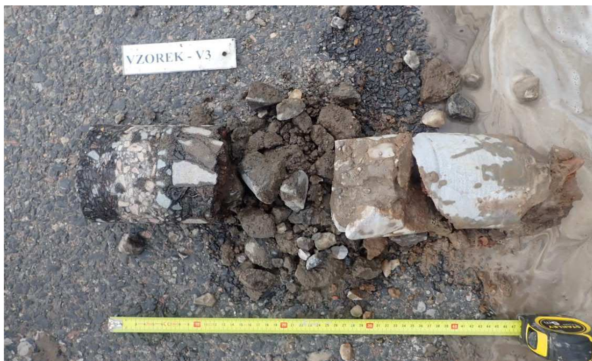
Obr. 5 - Jádro vývrtu Vzorek – V3 (in situ).
