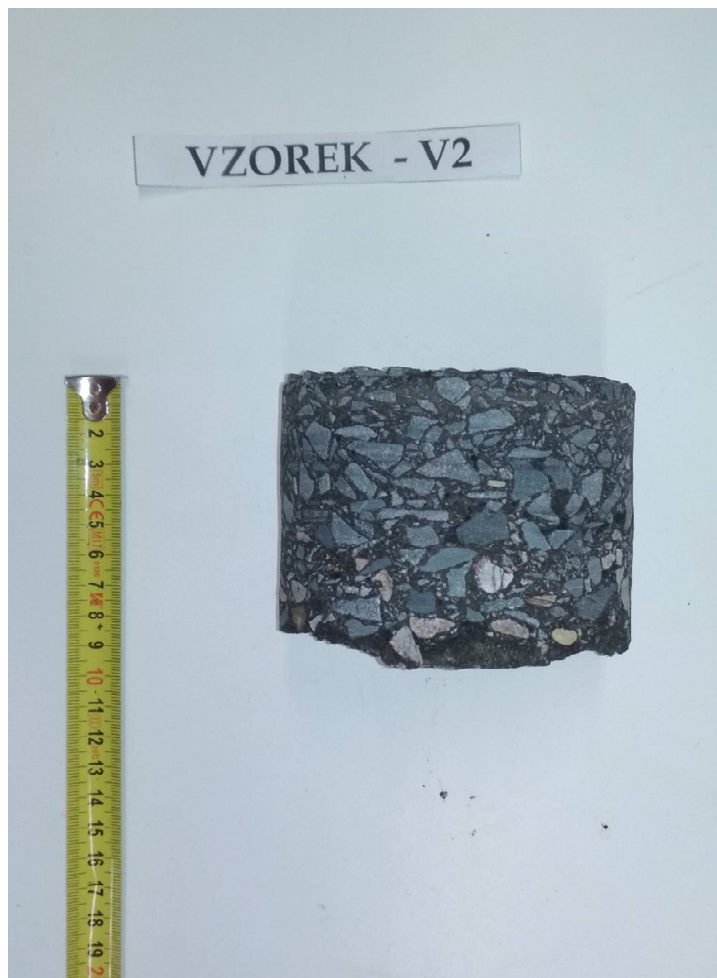
Obr. 4 - Jádru vývrtu Vzorek – V2 (laboratoř).
