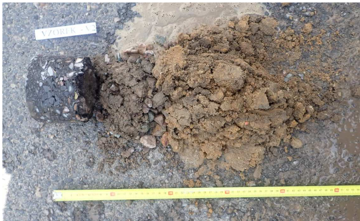
Obr. 3 - Jádro výtvetu Vzorek – V2 (in situ).
