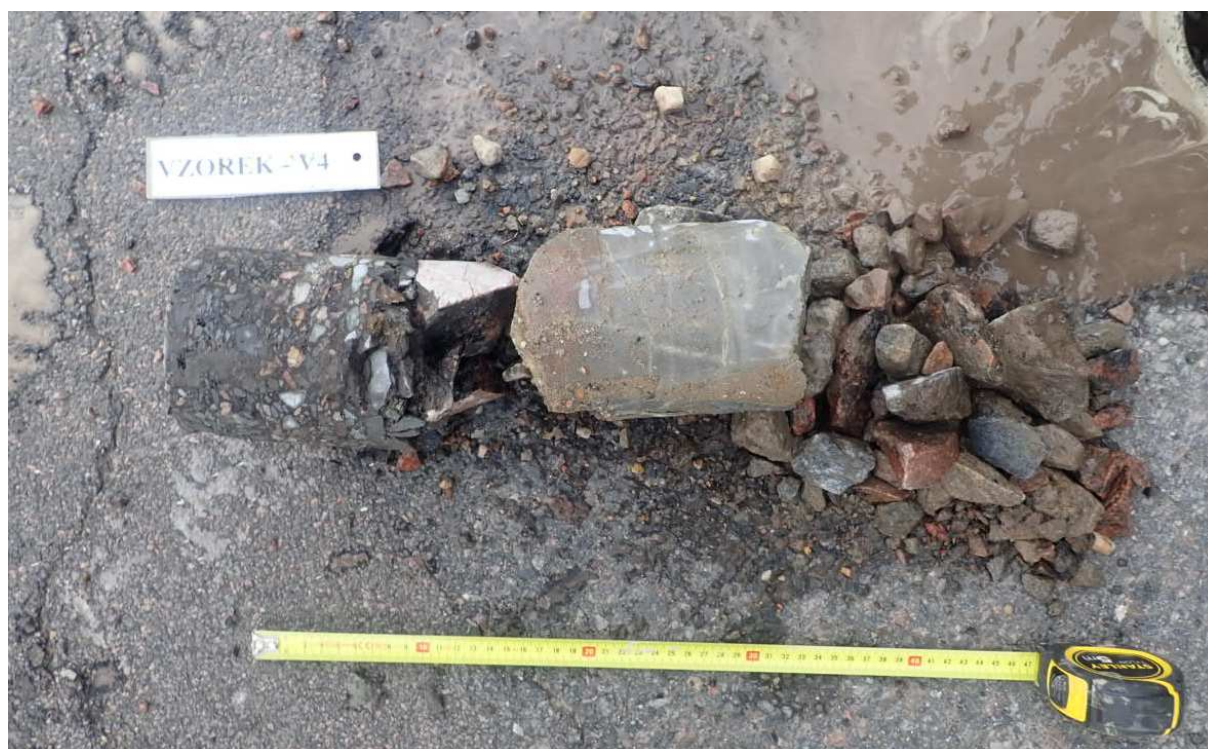
Obr. 7 - Jádro vývrtu Vzorek – V4 (in situ).
